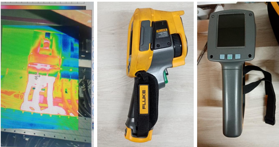
Ilustración 27 Detección de fugas de calor
