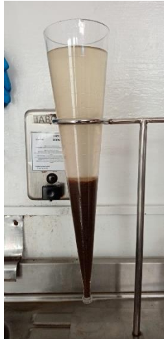
Ilustración 14 Muestra sólidos totales en cono sedimentador
