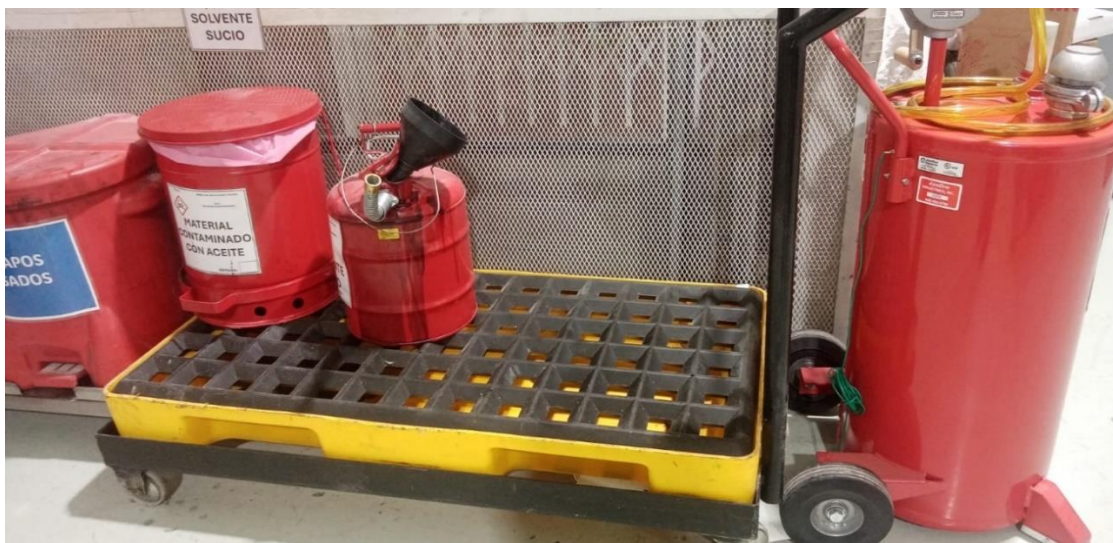
Ilustración 31 Orden, limpieza y separación de residuos lubricantes
